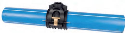
Anbohrschelle auf das Rohr setzen. Die untere Halbschale muss waagrecht angelegt werden. Das Kunststoffrohr muss riefenfrei sein. Bei Temperaturen unter + 5°C muss das Rohr vor der Montage vorgewärmt werden.
