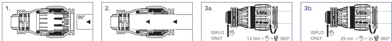
1. Das Rohr rechtwinklig und gratfrei abschneiden. Das Rohrende muss sauber und bei Metallrohren ebenfalls oxydfrei sein.
