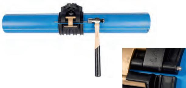
Durch das Einschlagen der Sicherungsbolzen wird der Bügel gesichert. Die korrekte Schließposition erkennt man daran, dass die Sicherungsbolzen an beiden Seiten 5 mm herausstehen.
