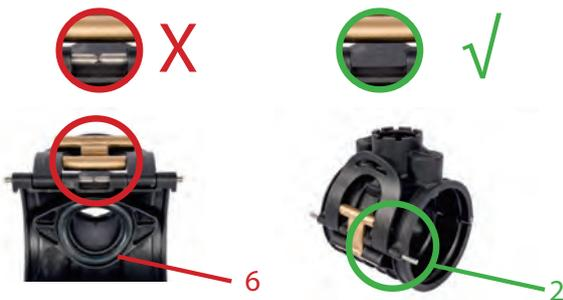
Position der Sicherungsbolzen überprüfen (2). Sicherstellen, dass sie herausstehen. Kontrollieren, dass die O-Ringe (6) korrekt sitzen. Prüfen, dass das Rohr die richtige Abmessung innerhalb der Toleranzen hat. \* (Siehe Übersicht Seite 37)
