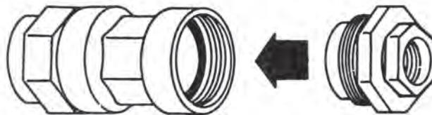
So kann man mit unseren Bauteilen alle Kunststoff-Übergänge der ISIFIO-Kupplungen verändern.
